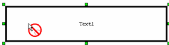
Exemple de zone de dépôt non valide pour une dimension glissée
